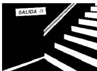
Recubrimiento de contrahuellas con pintura fotoluminiscente
